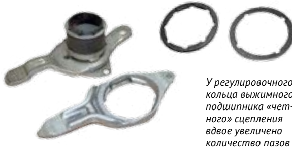
У вилок выключения сцепления четных передач изменилась форма и повысилась точность изготовления опорных элементов (вверху — обновленная вилка образца 2011 года)
