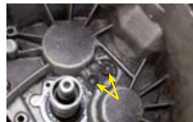
Окно для вилок выключения в картере коробки закрыли пластиковым экраном — для защиты обоих сцеплений от грязи
