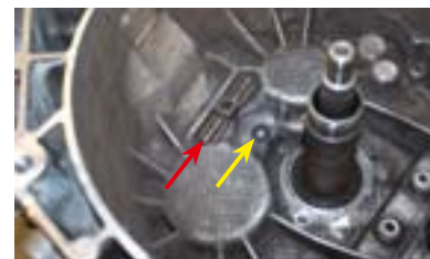
Опоры вилок выключения сцеплений в картере коробки передач сперва были пластиковыми (желтые стрелки на верхнем фото). С 2011 года полусфера вилки «четного» сцепления стальная (желтая стрелка на нижнем фото), а у «нечетного» — заменена стержнем (красная стрелка), обеспечивающим лучшую фиксацию вилки и точность работы механизма
