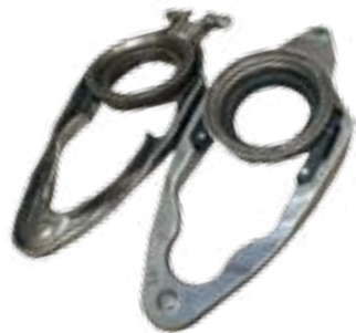
Литая вилка выключения сцепления нечетных передач из легкого сплава (справа) заменена штампованной стальной (слева)
