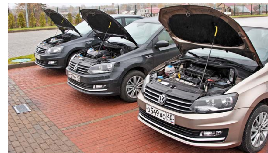
Старый мотор серии EA111 легко отличить по декоративной накладке, которая прикрывает лишь половину клапанной крышки (автомобиль на переднем плане). Новые двигатели EA211 (на заднем плане) закрыты сверху большим корпусом воздушного фильтра и ориентированы выпускным коллектором назад, как и предполагает фольксвагеновская платформа MQB
