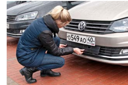
Мария Кох занимается адаптацией машин к российскому рынку — и сейчас демонстрирует легкосъемную пластиковую заглушку для нижней части бампера: она появится на всех Polo с 16 ноября — для защиты радиатора от грязи в зимнее время
