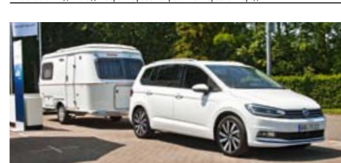
Электроника помогает маневрировать задним ходом с прицепом. Водителю нужно лишь выбрать желаемую траекторию «автоматом» с помощью джойстика настройки зеркал и нажимать на педаль — автомобиль будет сам вращать руль на необходимый угол
